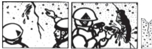
Đục bê tông hoặc đá hình chữ "V" xung quanh nơi rỉ nước. Làm sạch những mảnh vụn vỡ, tạp chất và làm sạch bề mặt bằng nước trước khi thi công Sika 102.
